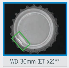
\* En utilisant l'accessoire Low Angle avec une distance de travail très courte, le Modular Ringlight crée un effet Darkfield comparable à celui obtenu avec un annulaire dédié Darkfield.
