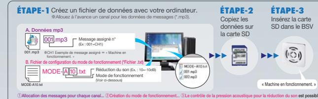
Lorsque vous utilisez le logiciel d'application exclusif, il est possible de combiner le réglage du volume d'un message ou d'ajuster le volume séparément.
