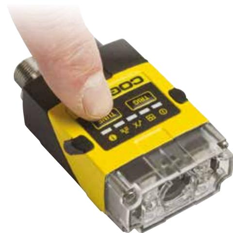
*Les boutons de réglage automatique et de déclenchement facilitent la configuration des lecteurs sans aucun PC.*
