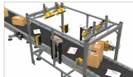
Intégration transparente au tunnel de lecture de codes-barres grâce à la technologie DataMan® Multi-Reader Sync™
